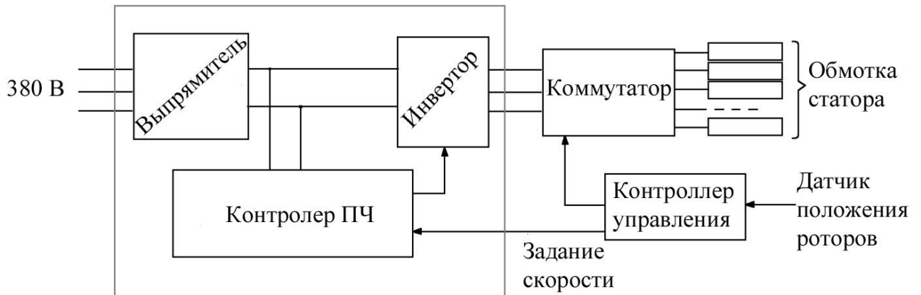
Рисунок 1.12 – Схема подключения с использованием ПЧ
