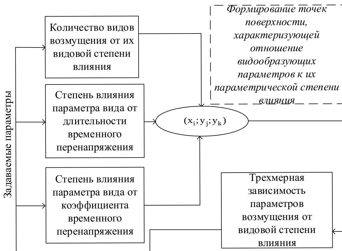
Рисунок 2.26. Описание процесса построения графических распределений для выявления интервала наиболее негативных возмущений (на примере перенапряжений)
