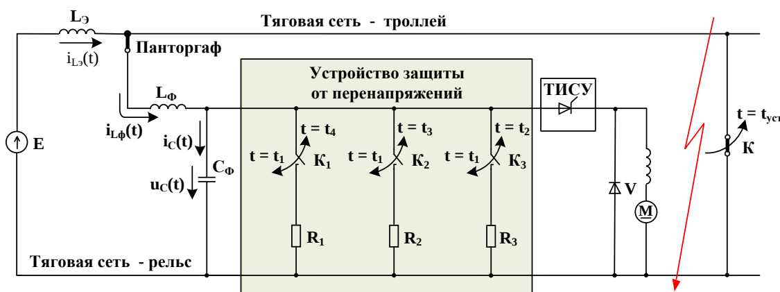
Рисунок 2 – Схема к пояснению способа защиты от коммутационных перенапряжений, основанного на использовании демпфирующих свойств конденсатора фильтра ТИСУ и трёх линейных резисторов
