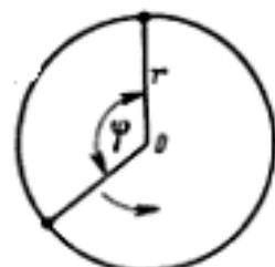
проводочного мотка), одна из которых неподвижна, а другая вращается с постоянной угловой скоростью  $\omega$ , что порождает индукционные токи в элементах схемы. Определить силу тока в подвижной проволоке в тот момент, когда угол между проволоками окажется равным  $\phi$ .
