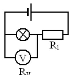
сопротивлением  $R_V = 4$  кОм, подключенный к зажимам лампочки (см.рис.), показывает напряжение  $U_V = 6$  В. Какое напряжение  $U_1$  будет на лампочке, если отключить вольтметр? Зависимостью сопротивления лампы от температуры нити накала пренебречь.
