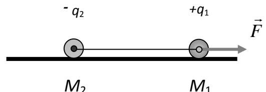
Шарики находятся на гладкой горизонтальной непроводящей поверхности. К первому шарику привязали другую нить и стали тянуть горизонтально с возрастающей силой. В момент, когда эта сила стала равна 12 Н, нить натянулась. Найти отношение масс шариков ( $M_1/M_2=?$ )
