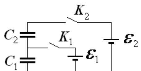
замыкают ключ  $K_2$ . Найти установившееся напряжение на конденсаторе  $C_2$ . Емкости конденсаторов и ЭДС источников, обозначенные на схеме, считать известными.
