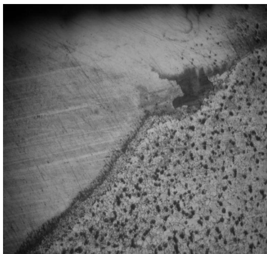
Рис. 7. Микроструктура сварного соединения (сварной шов слева), выполненного электродами UTP 85 FN
