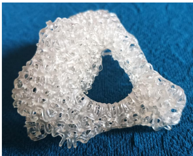
Рис. 10. Имитационный прототип имплантата позвонка с нерегулярной решеткой Вороного, отпечатанный на 3D-принтере DLP
