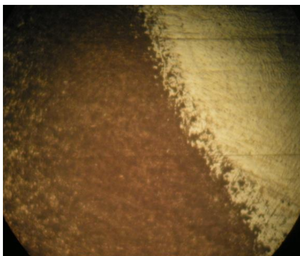
Рис. 4. Микроструктура сварного соединения (сварной шов справа), выполненного электродами GEKATEK Fe-CAST
