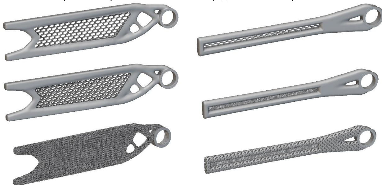
Рис. 6. Примеры ячеистых и сетчатых структур
