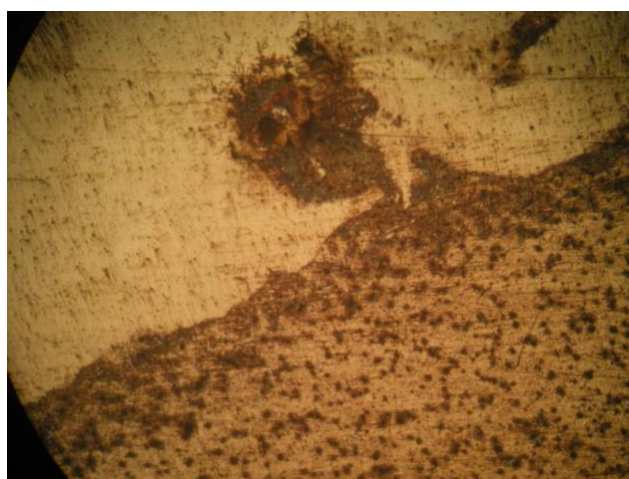
Рис. 3. Микроструктура сварного соединения (сварной шов сверху), выполненного электродами SUPER Ni
