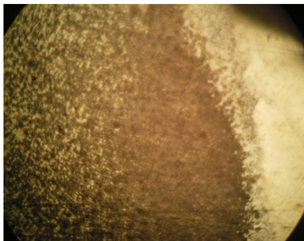
Рис. 2. Микроструктура сварного соединения (сварной шов справа), выполненного электродами CAST Ni Fe B
