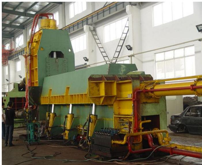
Рис. 7. Гидравлические пресс-ножницы
