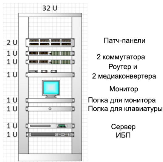
Рис. 4. Схема наполнения серверной стойки
