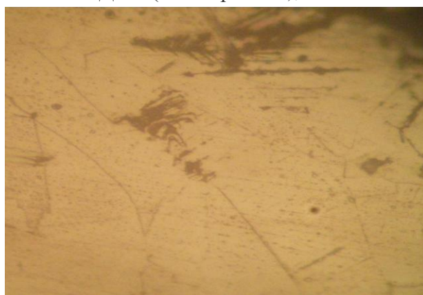
Рис. 5. Структура металла сварного шва при повышении значения погонной энергии до 1504 кДж/м (балл зерна 3–4), \times 100
