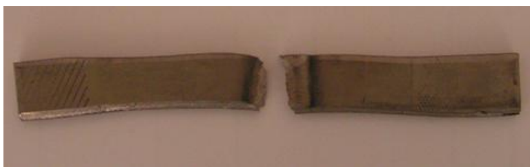
Рис. 2. Сварные образцы после испытания на разрывной машине
