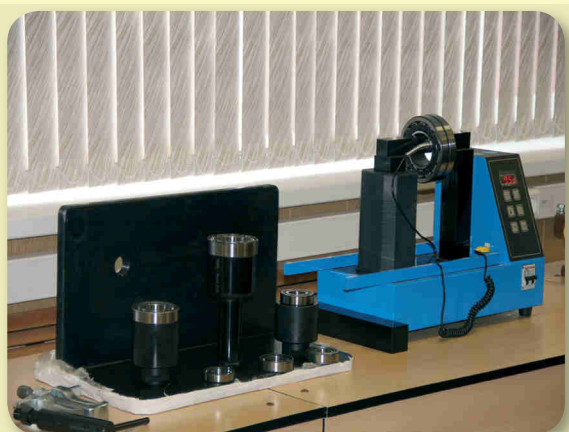
Индукционный нагреватель для нагрева подшипника перед сборкой
