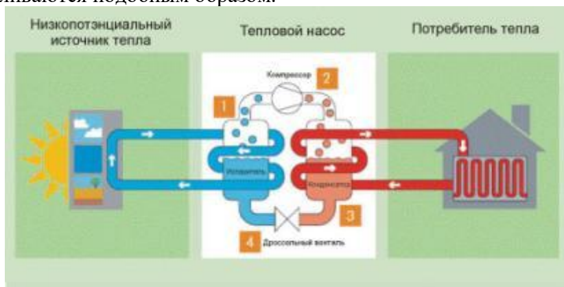
Рисунок 2 – принцип работы теплового насоса
