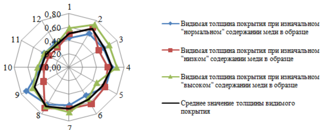
Рисунок 1 – Гистограмма толщины покрытия на латунированной проволоке диаметром 0,30 мм в SE детекторе, мкм
