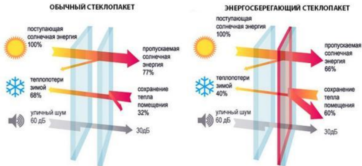
Рисунок 1. Сравнение энергоэффективного и обычного стеклопакетов
