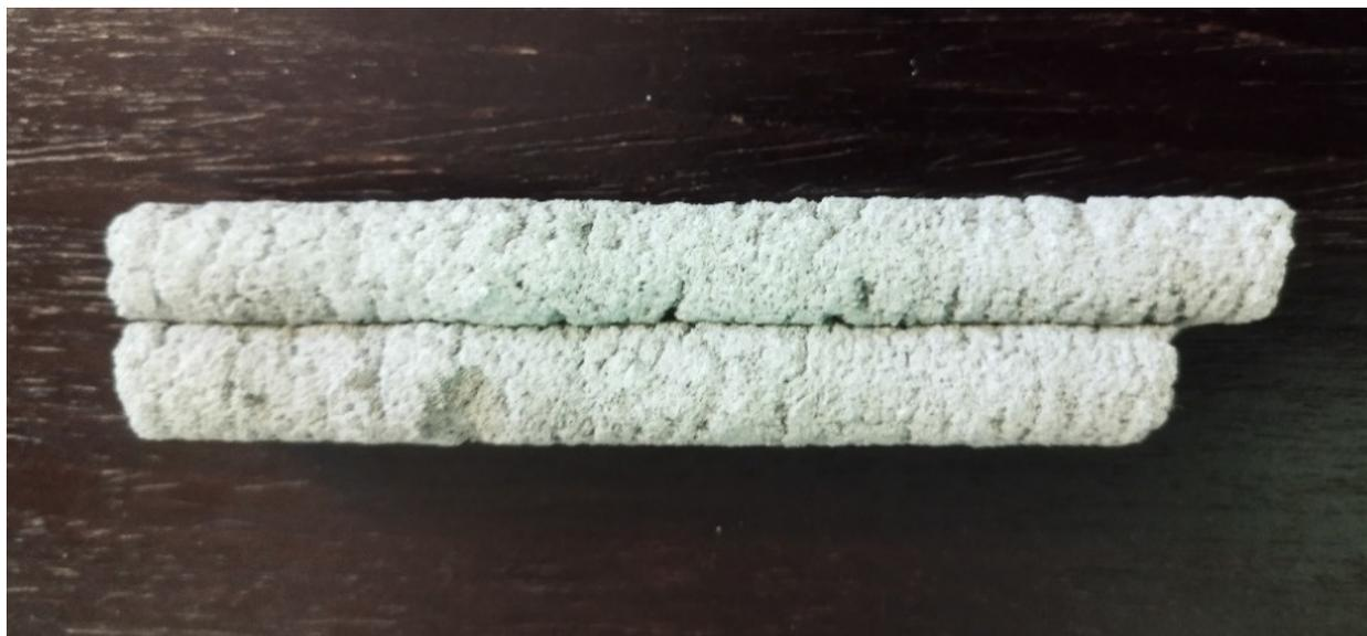
Рисунок 1 – Напечатанный на 3D принтере бетон
